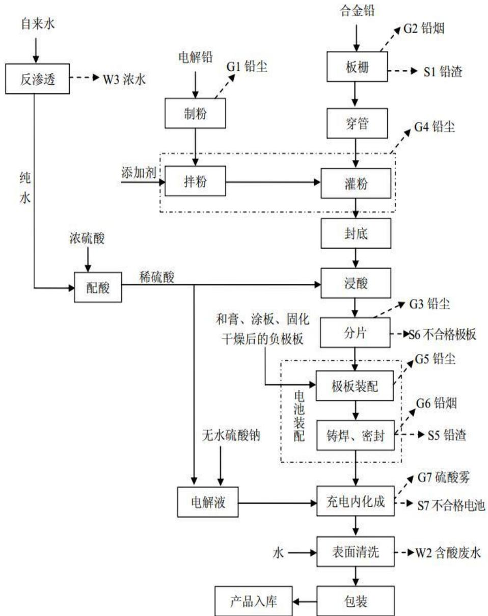
图 3-2 牵引性蓄电池工艺流程及产污环节
