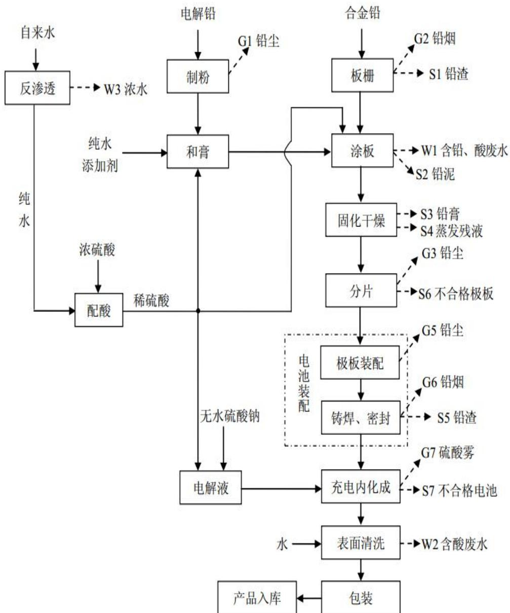
图 2-1 铅蓄电池工序及产污环节
