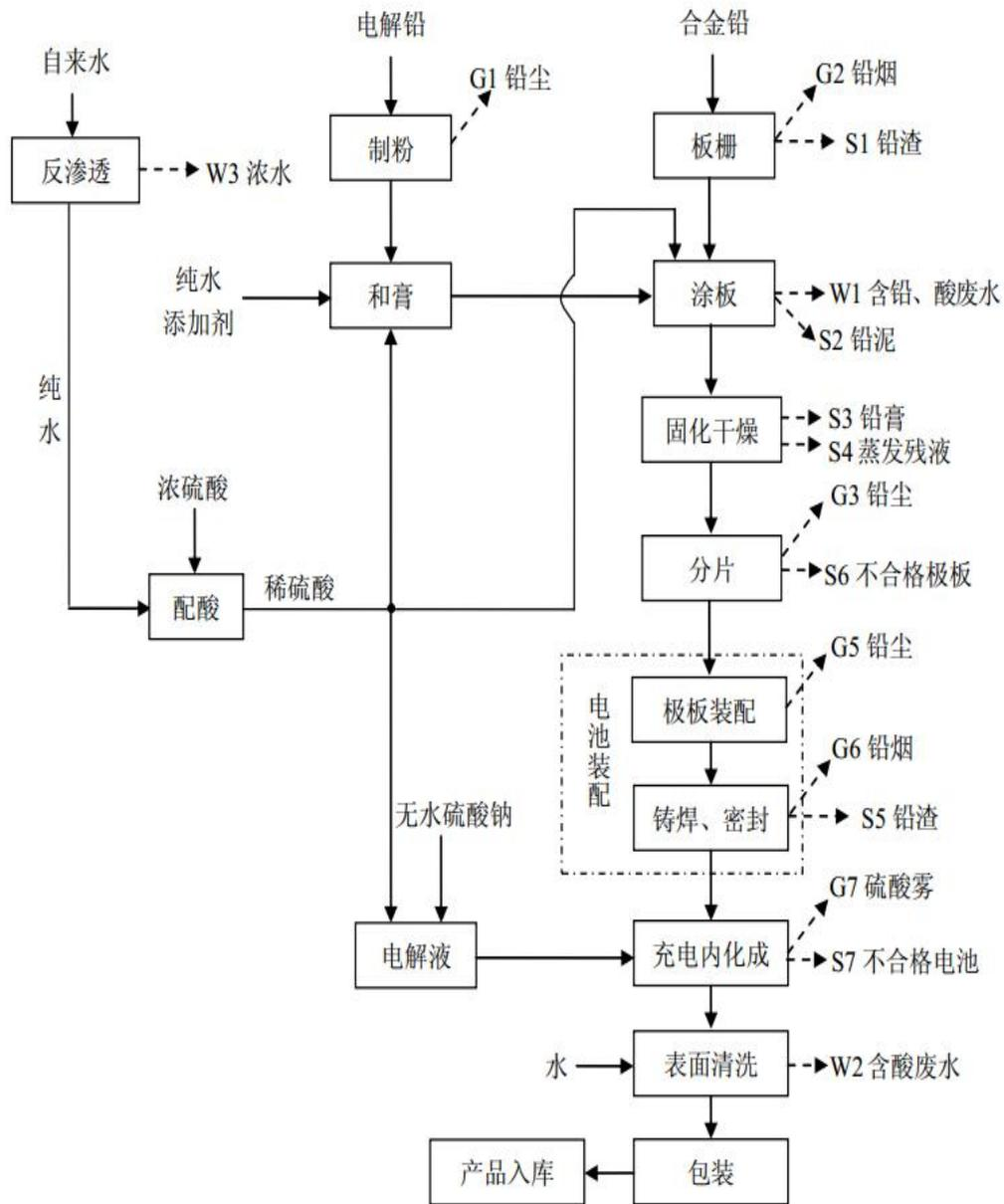
图 3-1 铅蓄电池工序及产污环节
